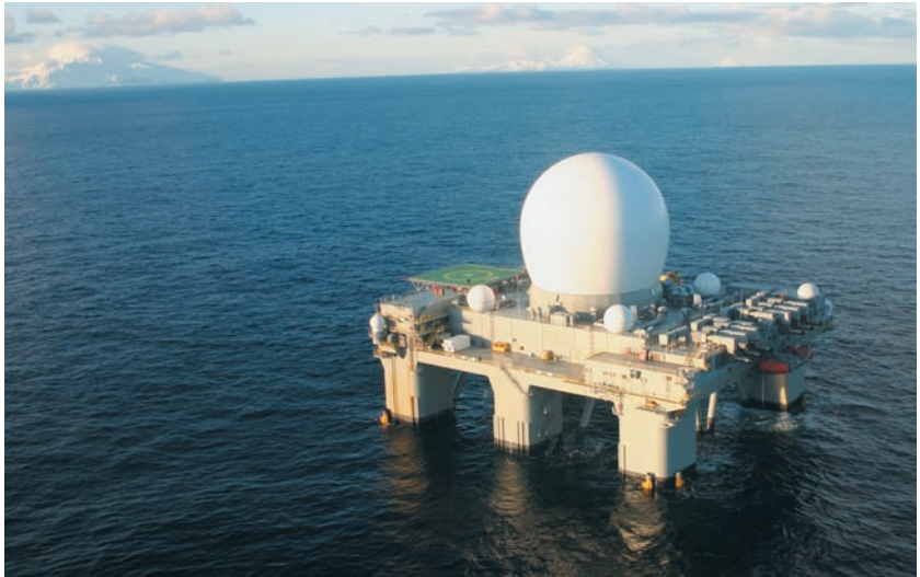
Радиолокационная станция морского базирования X-диапазона в районе Алеутских островов. Фотография предоставлена Missile Defense Agency ( http://www.mda.mil/global/images/system/sbx/img_2845.jpg )
