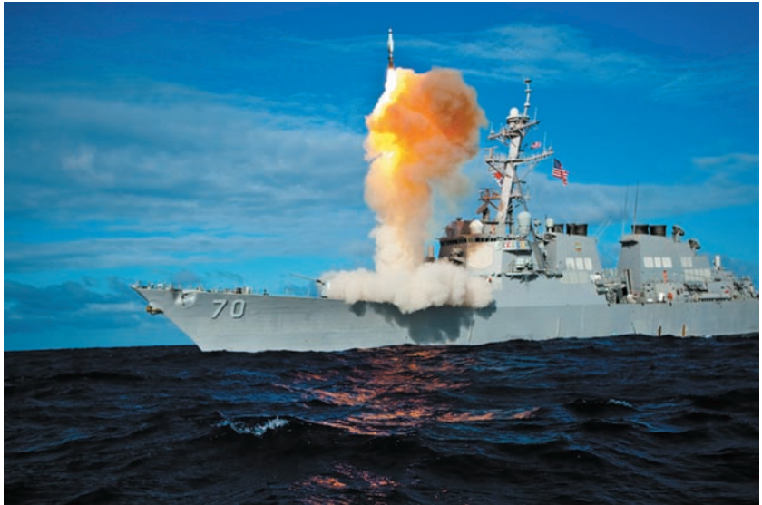
Испытательный пуск противоракеты «Стандарт-3» с эсминца «Хоппер» типа «Арли Берк», оснащенного боевой информационно-управляющей системой «Иджис-ПРО». Фотография предоставлена Missile Defense Agency ( http://www.mda.mil/global/images/system/aegis/ftm17hopper.jpg )
